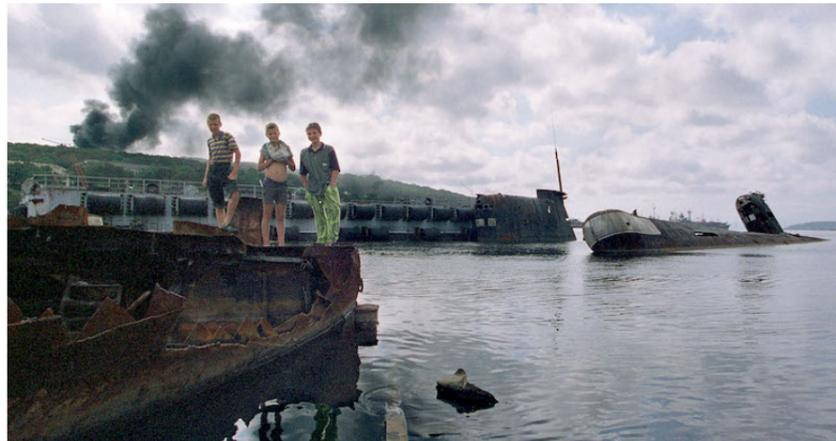
spécialisé et de longues plongées, pendant plusieurs périodes : la première phase du démantèlement consiste à retirer les réacteurs présents (en plus des éventuels missiles à têtes nucléaires montés sur le sous-marin), puis l'extraction de la matière radioactive du réacteur :
